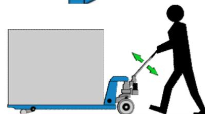
Груз поднимается при движении ручки гидравлической тележки.
